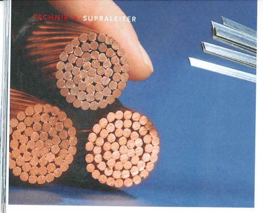
Größenvergleich: Supraleiter benötigen zur Übertragung von Strom eine deutlich geringere Fläche als Kupferkabel (links).
